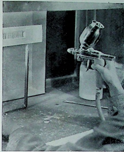
Bild 14. Besprühung der Kathodenröhren. Links: Besprühung der Kathodenröhren mit halbherausgezogener und besprühter Heizwendel
