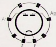
Bild 290a. Sockelschaltg. AZ 1
