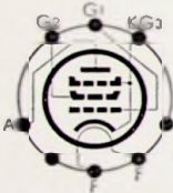
Bild 341. Sockelschaltung für EL 11 und 12
