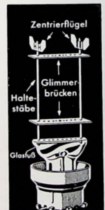
Bild 28c. Vereinfachter Aufbau mit Glimmerbrücken
