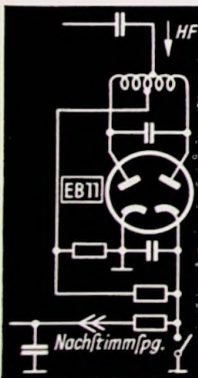
Bild 312. Prinzipschaltung zur Erzeugung der Nachstimmspannung bei selbsttätiger Scharfabstimmung
