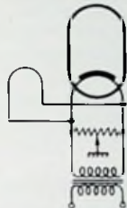
Bild 169a. Wechsel- stromheizung, direkt
