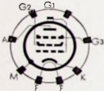
Bild 246. Sockelschaltung für AF 7/CF 7
