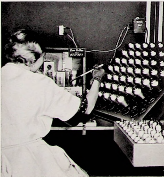
Bild 260. Jede Röhre wird bei der Herstellung auf Klingsicherheit untersucht
