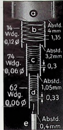
Bild 16. Die drei Gitter einer Hochfrequenzpentode (Beispiel AF 3)
