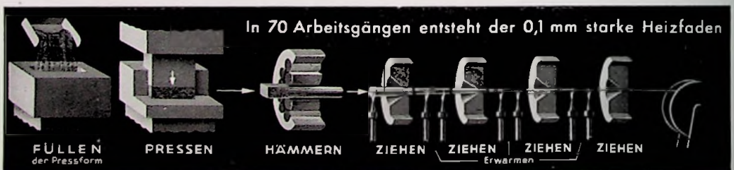
Bild 233. Die Herstellung des Heizfadens der Rundfunkröhren
