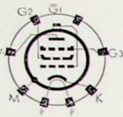
Bild 390. Sockelschaltung für VF 7
