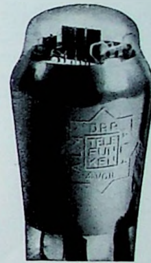
Bild 31. Endpentode AL 4 (innen geschwärzter Kolben)
