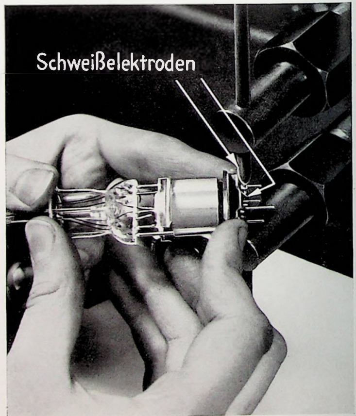
Bild 270. 20 bis 40 Schweißstellen sind bei jeder Röhre vorhanden und geben dem Systemaufbau sicheren Halt
